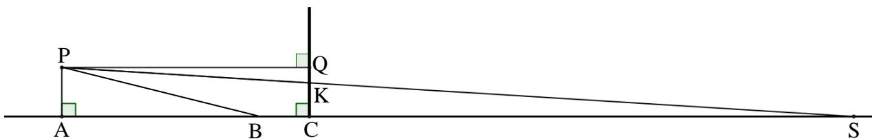
Pour que l'éclairage d'une voiture soit conforme, les constructeurs déterminent l'inclinaison du faisceau. Cette inclinaison correspond au rapport  $\frac{QK}{QP}$ . Elle est correcte si ce rapport est compris entre 0,01 et 0,015.
